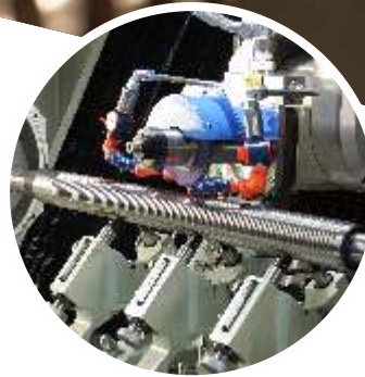
CNC Profil-Schleifmaschine mit 6 Achsen Made in Germany
